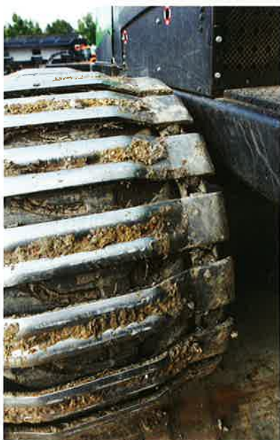
Auf den Rädern der Hinterachse sind 93 cm breite Magnum-Bogiebänder angebracht.
